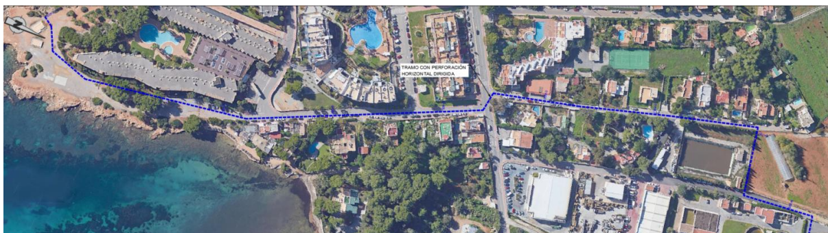
Figura 8: Trazado nueva tubería de agua de mar
