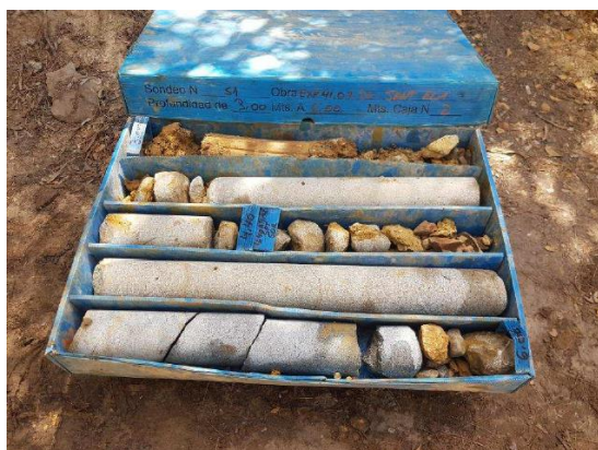
Imagen 4. Caja porta testigos. Sondeo 1, cajas 2 y 3.
