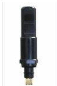
Fotografía 5 Turbidímetro STM SeaPoint
