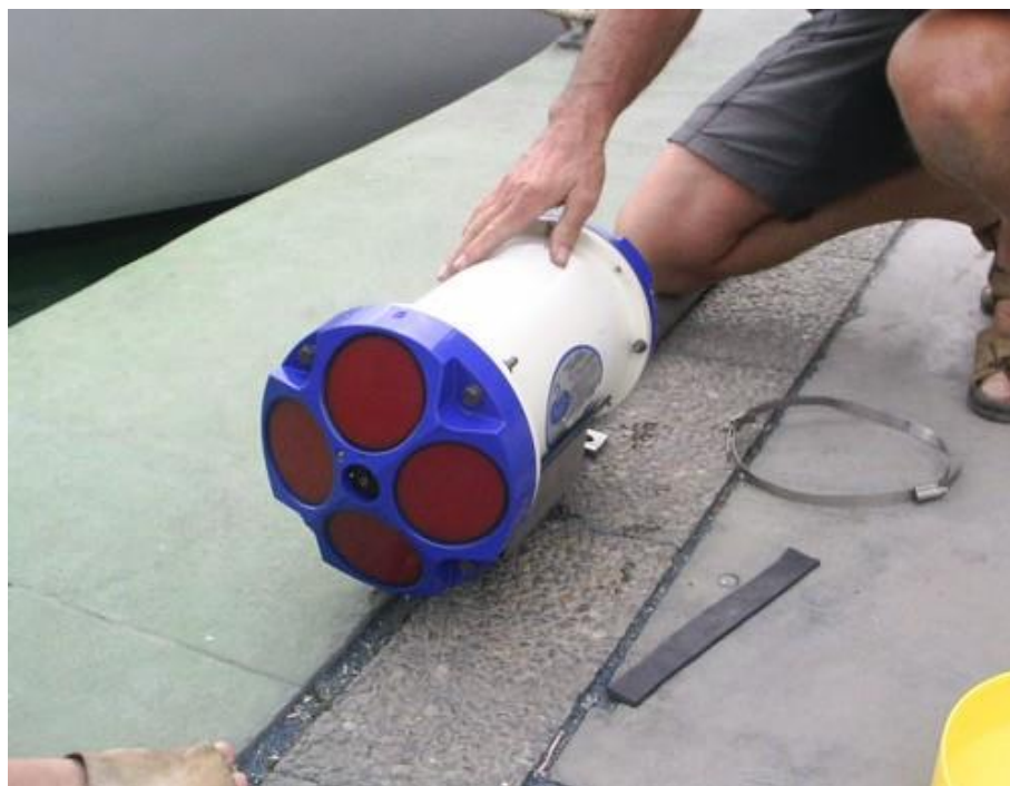
Fotografía 19 Instruments Equipo ADCP Workhorse Sentinel de RD Instruments
