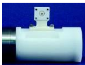
Fotografía 3 Sensor de Oxígeno disuelto SBE 43
