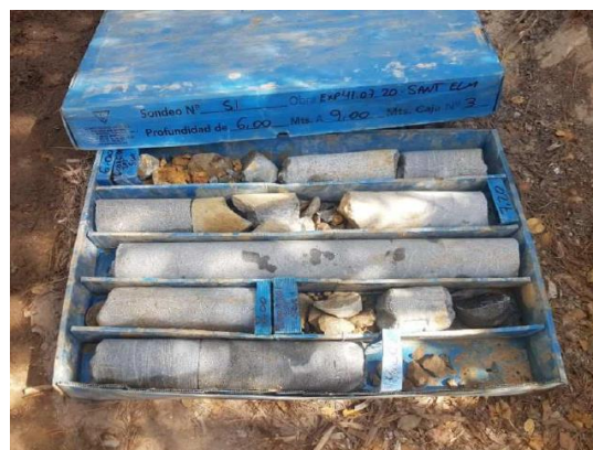
Imagen 4. Caja porta testigos. Sondeo 1, cajas 2 y 3.
