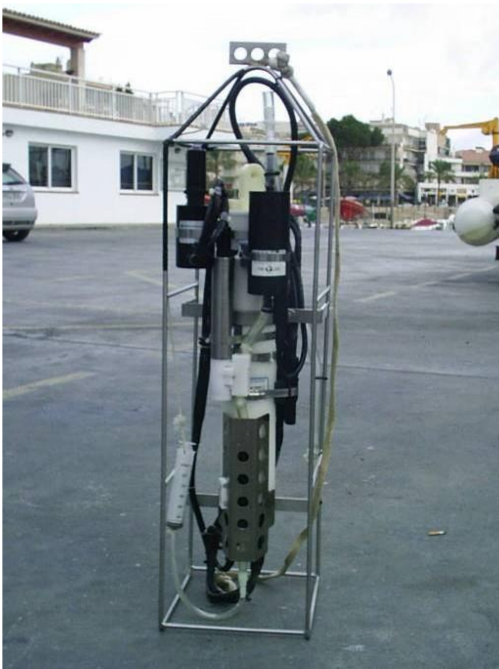
Fotografía 15 Equipo CTD SBE 19 SEACAT Profiler. Con los sensores oceanográficos adaptados
