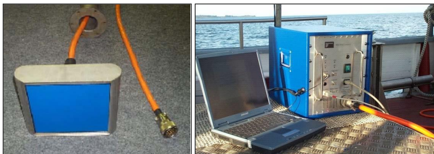
Figura 17. Perfilador de fondos INNOMAR SES-2000 COMPACT; transductor y centralita electrónica del sondador, respectivamente.
