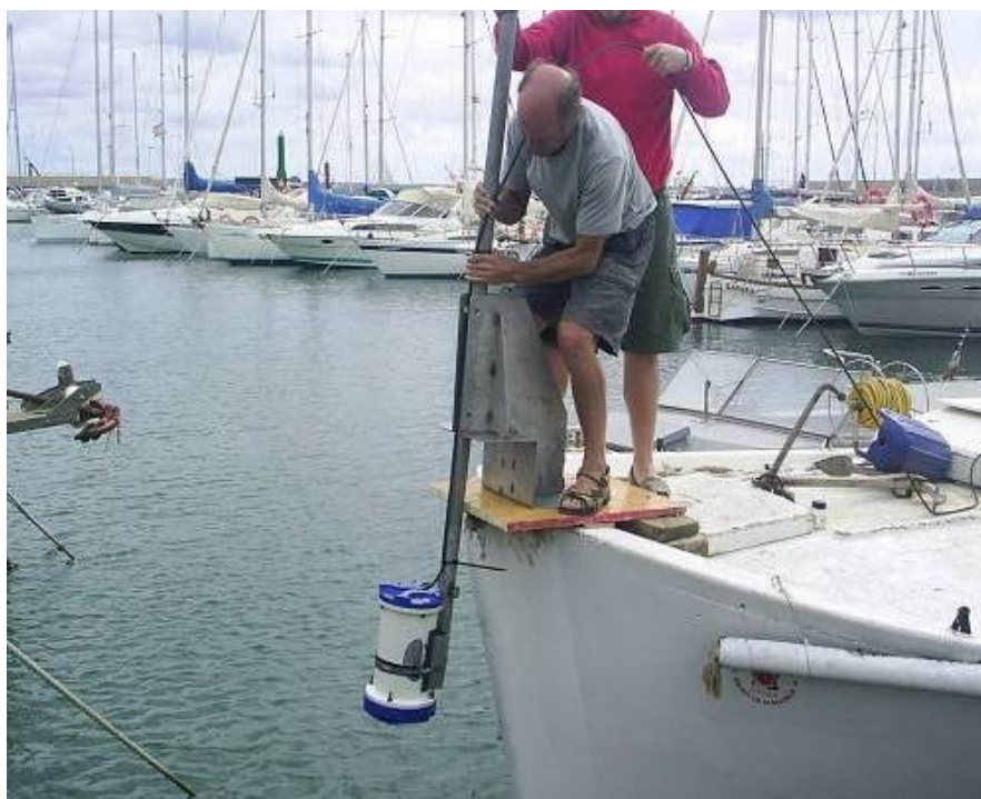
Fotografía 123 Instalación ADCP en la embarcación
