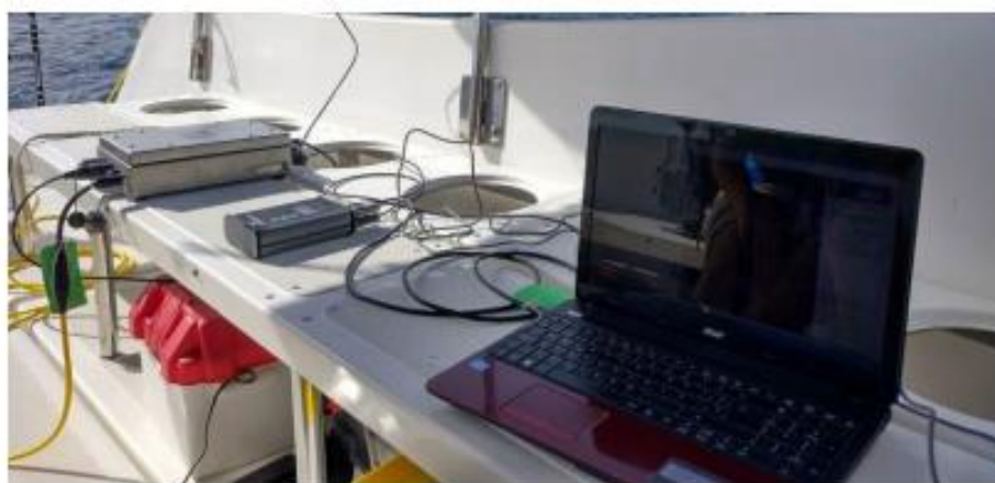
Imagen 4. GPS Diferencial y equipos para la obtención, visualización y grabación en tiempo real de los sonogramas en campo. Fuente. © OCEANSNELL, S.L.
