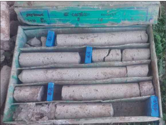
FOTO 3. Caja Portatestigos SONDEO 1 CAJA 2 (5.0-10.0m)
