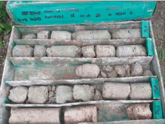
FOTO 5. Caja Portatestigos SONDEO 1 CAJA 3 (15.0-20.0m)
