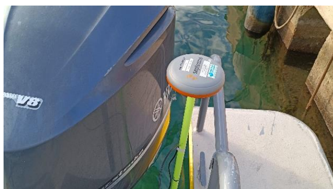
Imagen 2: Receptor RTK Altus NR3 ©OCEANSNELL
