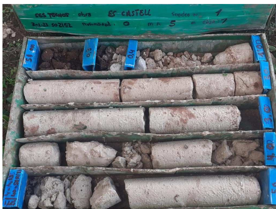
Foto 2: Caja porta testigos SONDEO 1 CAJA 1
