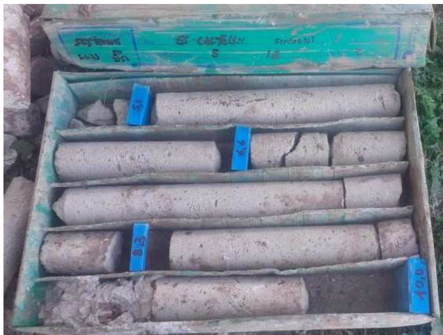
Foto 3: Caja porta testigos SONDEO 1 CAJA 2
