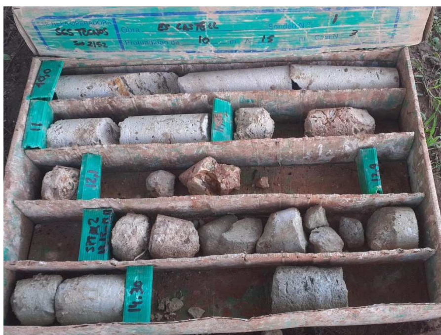
Foto 4: Caja porta testigos SONDEO 1 CAJA 3
