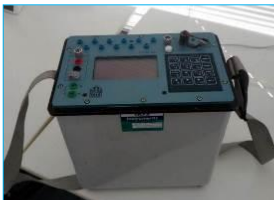
Figura 8: Resistivímetro SYSCAL IRIS PRO SWITCH 48.
