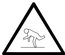
CAIDAS AL MISMO NIVEL
