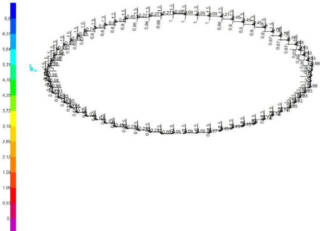
*Cargas transmitidas por los muros prefabricados*
