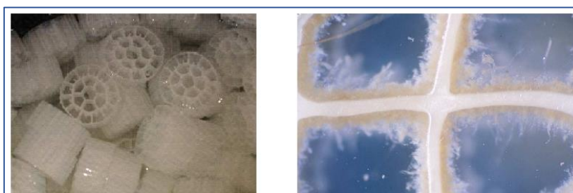
Formación de biopelícula en soporte plástico
