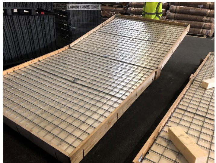
Figura 11 Islas flotantes para ser rellenas de gravas (Fuente: Aquaterra Solutions)
