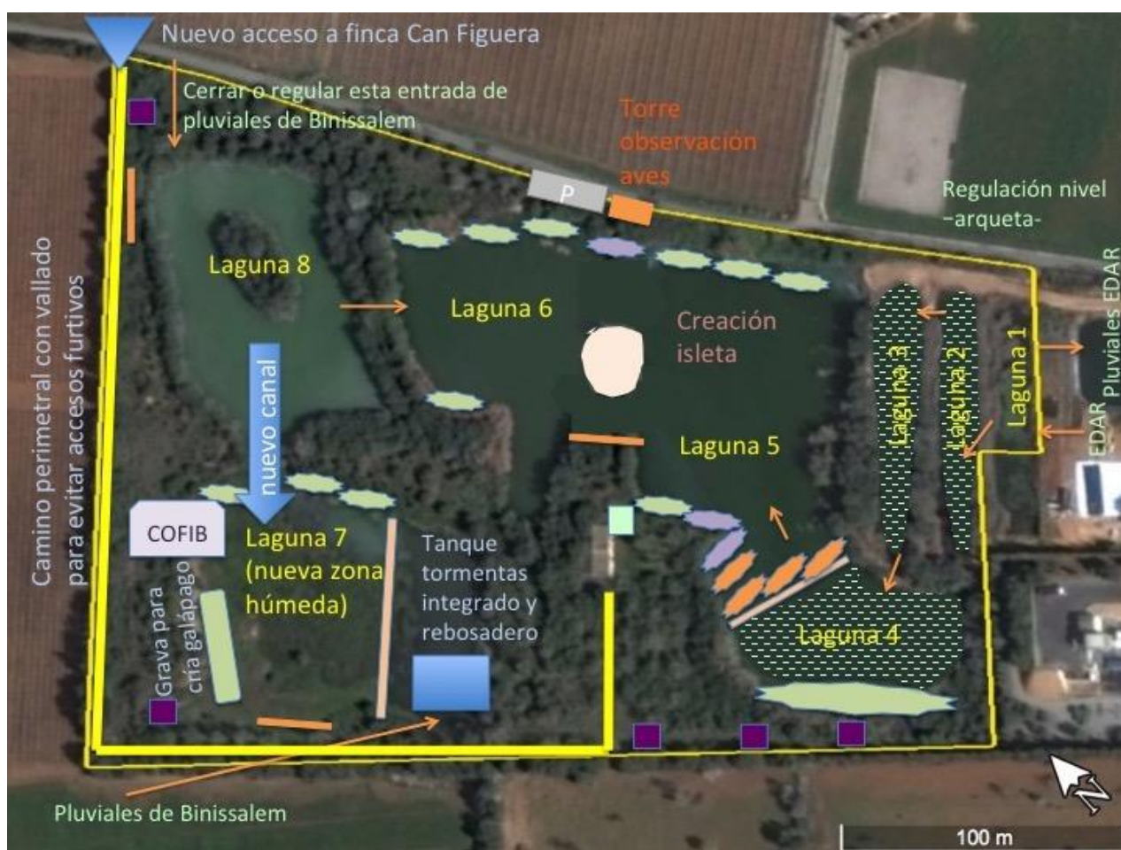
Figura 1 Croquis de las lagunas artificiales de Can Figuera, indicando las flechas naranjas los flujos de agua y su origen (texto verde claro). Se incluyen las actuaciones propuestas en el documento de WWF.
