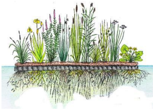
Figura 26 Esquema de una isla flotante
