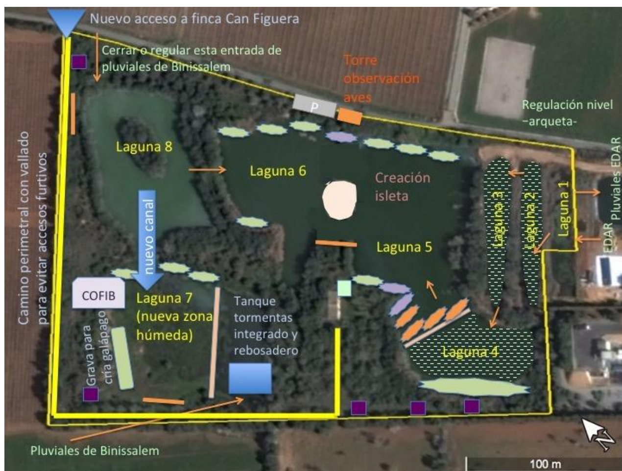
Figura 2 Croquis de las lagunas artificiales de Can Figuera, indicando las flechas naranjas los flujos de agua y su origen en texto verde claro. Se incluyen las actuaciones propuestas en el documento de WWF.
