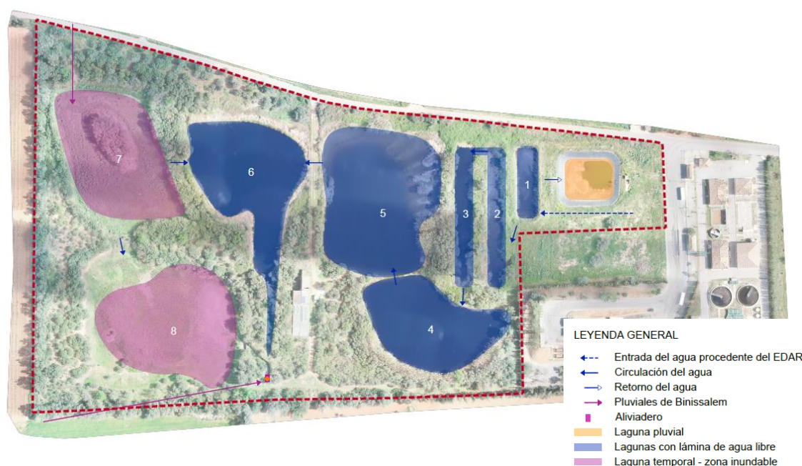
Figura 5 Funcionamiento general del sistema hídrico de la EDAR de Binissalem.
