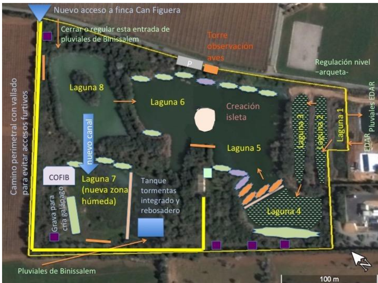
Figura 1 Croquis de las lagunas artificiales de Can Figuera, indicando las flechas naranjas los flujos de agua y su origen en texto verde claro. Se incluyen las actuaciones propuestas en el documento de WWF.
