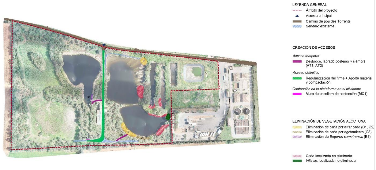
Figura 1 plano 4.1 Trabajos previos. Creación de accesos y eliminación de vegetación alóctona
