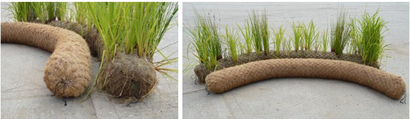
Figura 15 Rollos de fibra de coco de alta densidad tipo fiber roll sin vegetar y vegetados.
