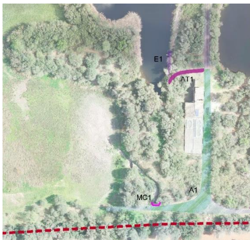
Figura 6 Situación en planta de la escollera (MC1)
