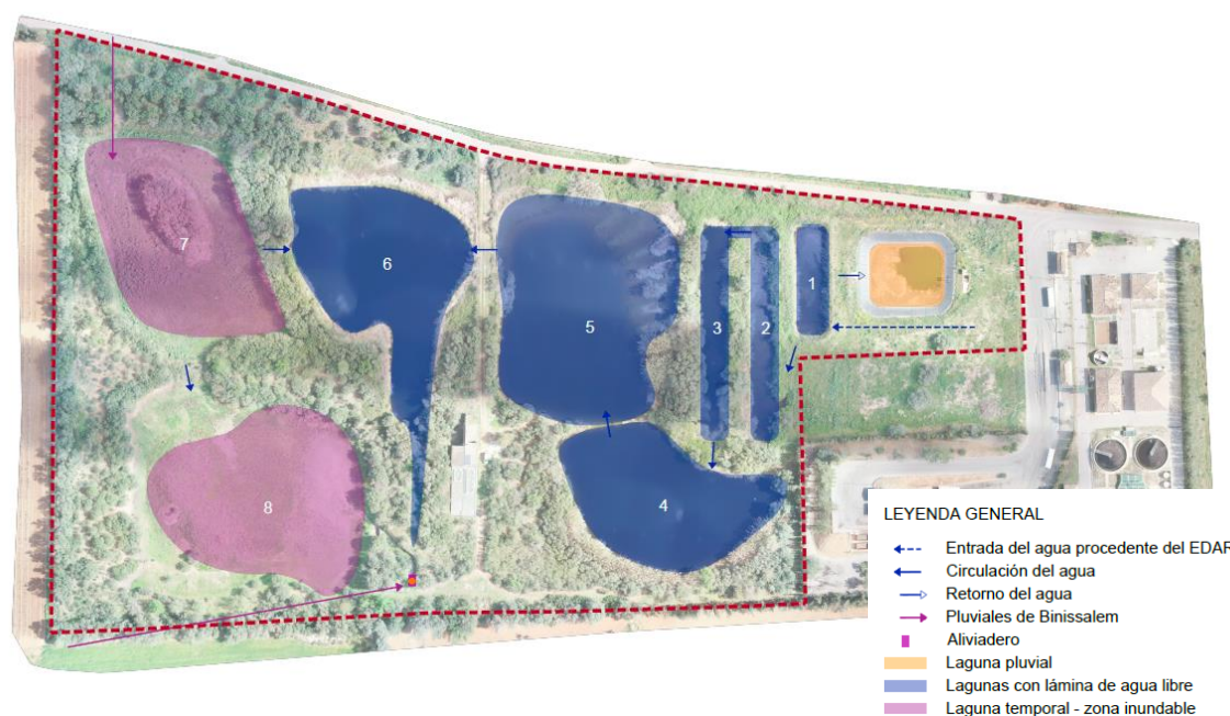
Figura 6 Funcionamiento general del sistema hídrico de la EDAR de Binissalem.
