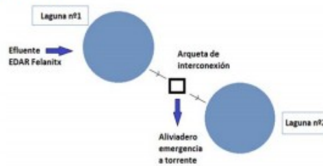
Figura 1: Esquema del sistema d'efluent i abocament de l'EDAR de Felanitx Font: Projecte
