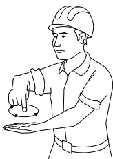
10 BAJAR EL AGUILÓN O PLUMA Y LEVANTAR LA CARGA
