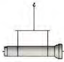
ÚTIL ESLINGA DE CINTAS CON PUENTE
