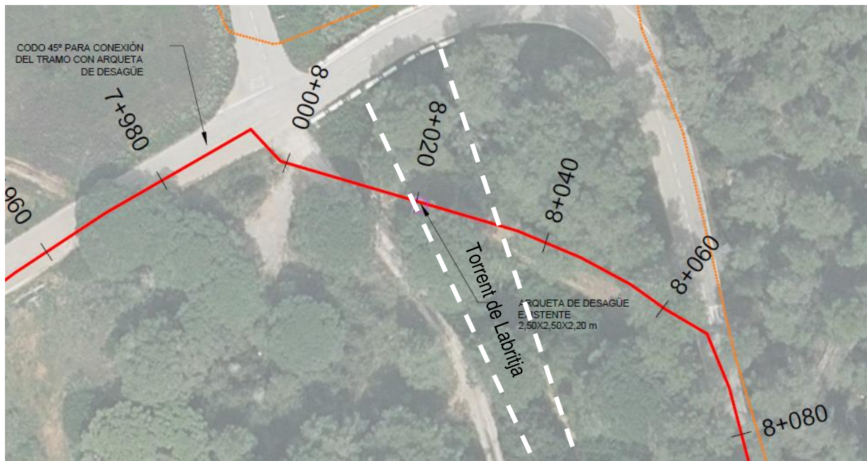
Ilustración 2 Detalle del trazado actual de la conducción a través del Torrent de Labritja. Fuente: Elaboración Propia
