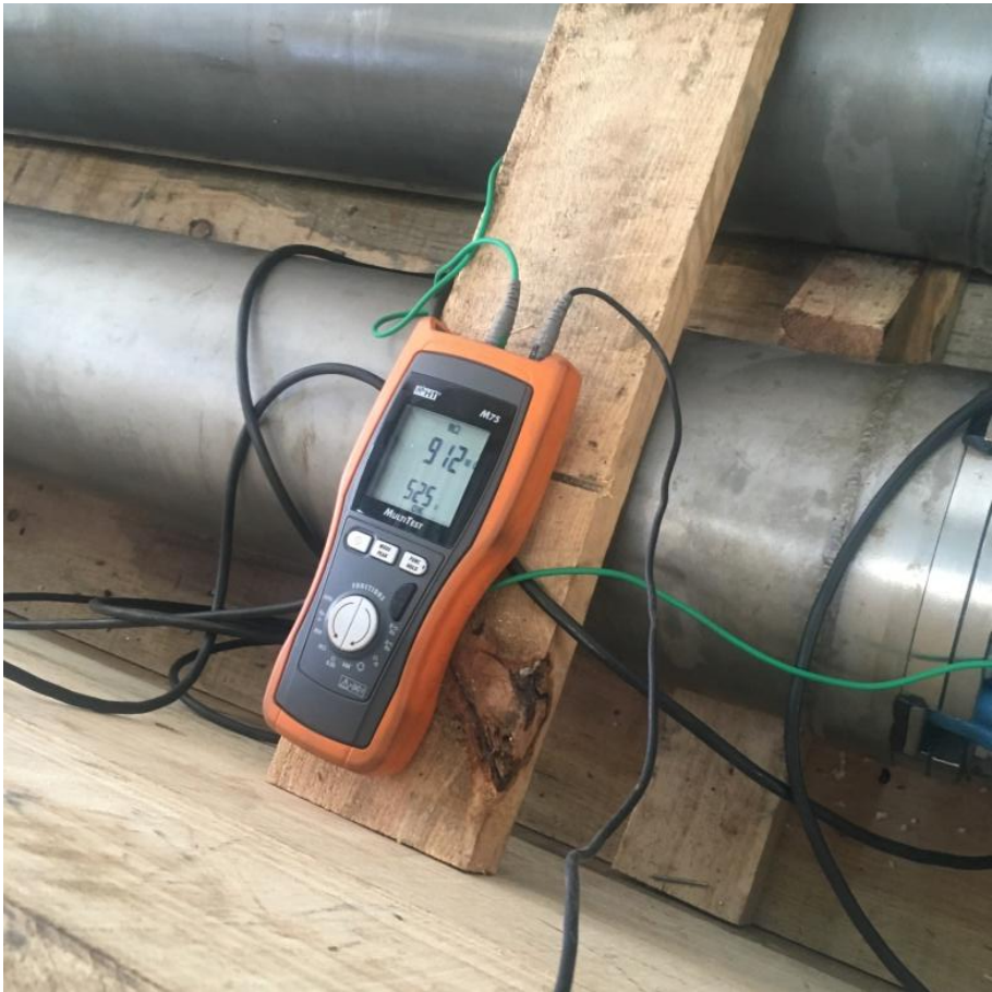
Foto 9 Bombas sumergible de Cantara reparadas y proceso de nuevo Megado.
